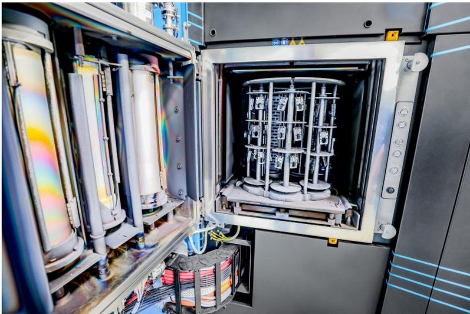
Durch den Einsatz von bis zu vier Targets können die Eigenschaften verschiedener Werkstoffe auf die Bauteile übertragen werden (Bild: Werz).
