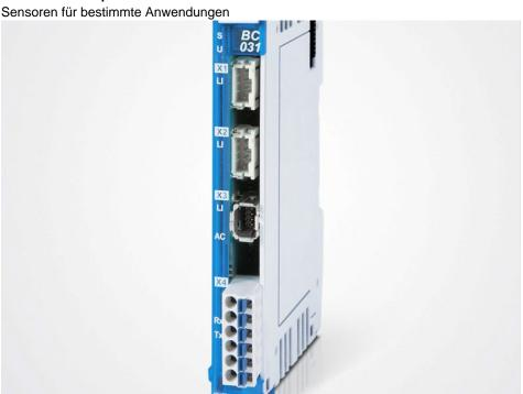
Das Gyroskop-Senosormodul misst Drehraten- und Beschleunigung. Bild: Sigmatek
