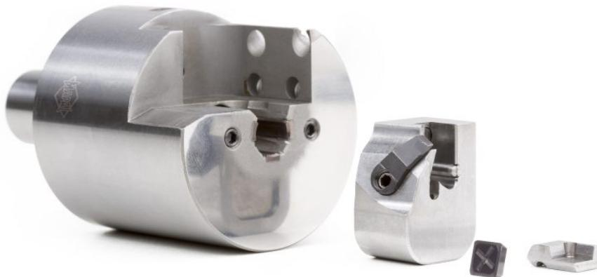
Um das Einstellen von Außenreibbahnen mit kleinen Durchmessern zu erleichtern, ist das »EA-System« in eine ausbaubare Kassette integriert. Bild: Mapal
