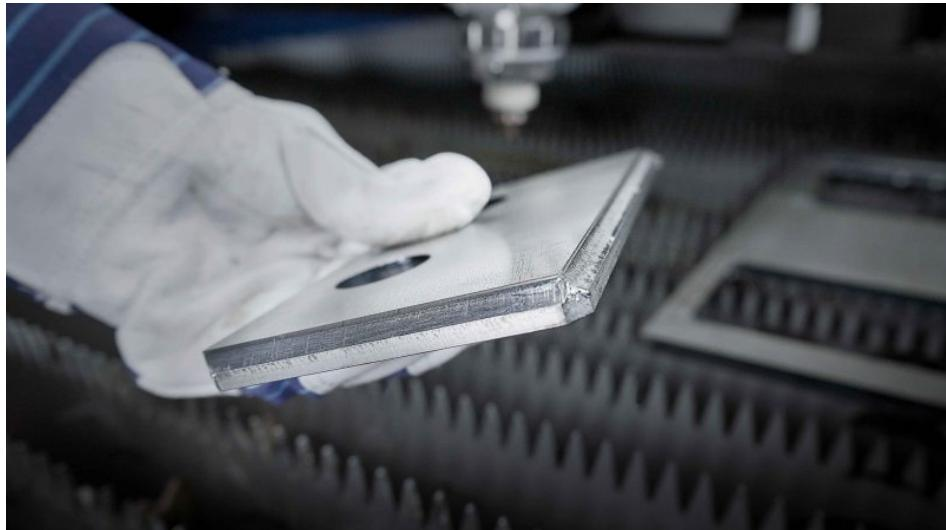
Die neue Laserschneidmaschine bereitet die Schweißkanten vor, indem sie während des Schneidens automatisch schräge Schnittkanten an den Konturen der Bauteile erzeugt (Bild: Trumpf).
