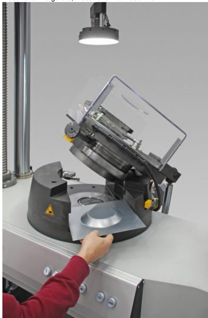
Die neue Tiefzieh-Prüfeinrichtung von Zwick Roell ist für unterschiedliche Verfahren
