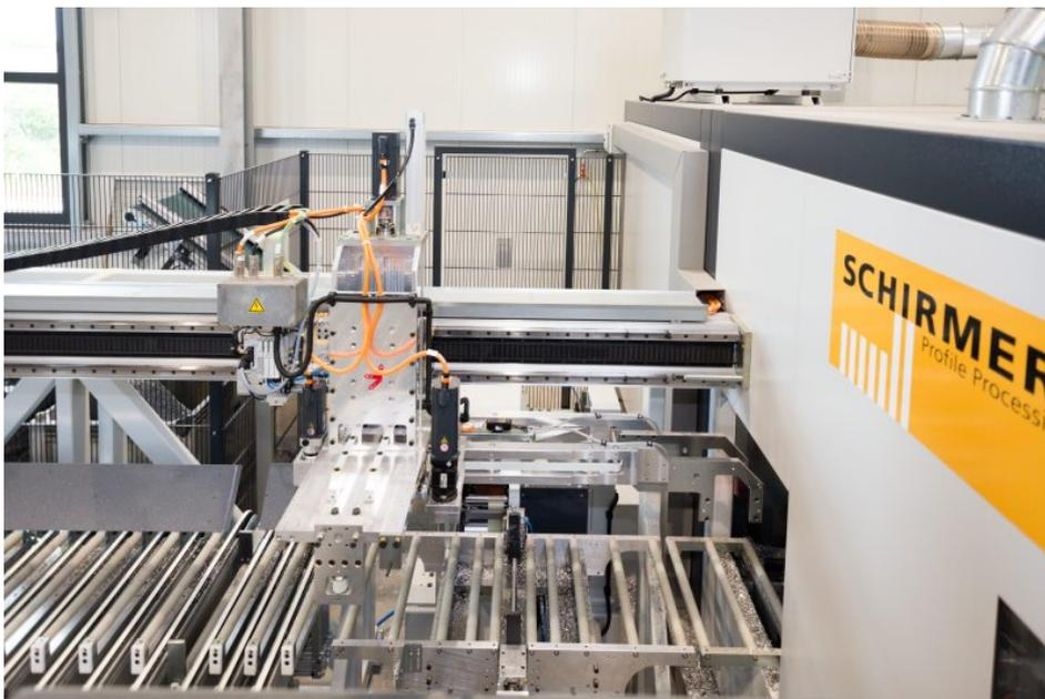
Beispiel für eine Anlage zur Profilbearbeitung (Bild: Schirmer).
