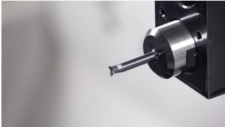
Das Werkzeug besitzt drei Schneiden zur hochpräzisen und effizienten Innenbearbeitung von Miniaturbauteilen (Bild: Iscar).
