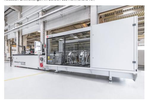
Die Honmaschine »deephone 3000« ist für das präzise Rohrhonen großer Werkstücke konzipiert (Bild: Gehrint).
