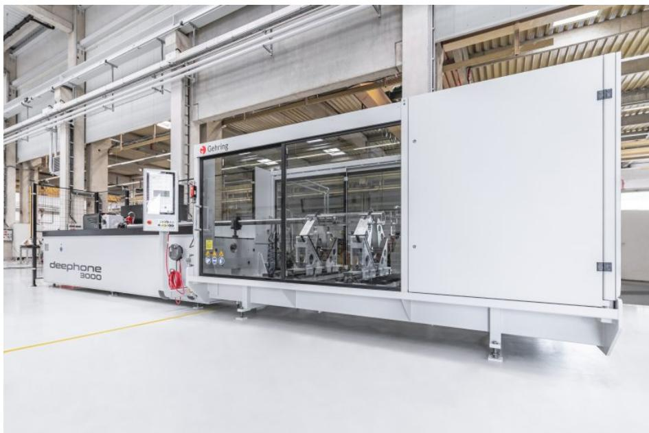
Die Honmaschine »deephone 3000« ist für das präzise Rohrhonnen großer Werkstücke konzipiert (Bild: Gehring).
