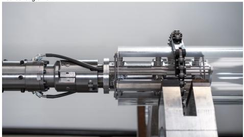
Präzisionshonen mit integrierter Innenkühlung und schnellem Werkzeugwechsel (Bild: Gehring).
