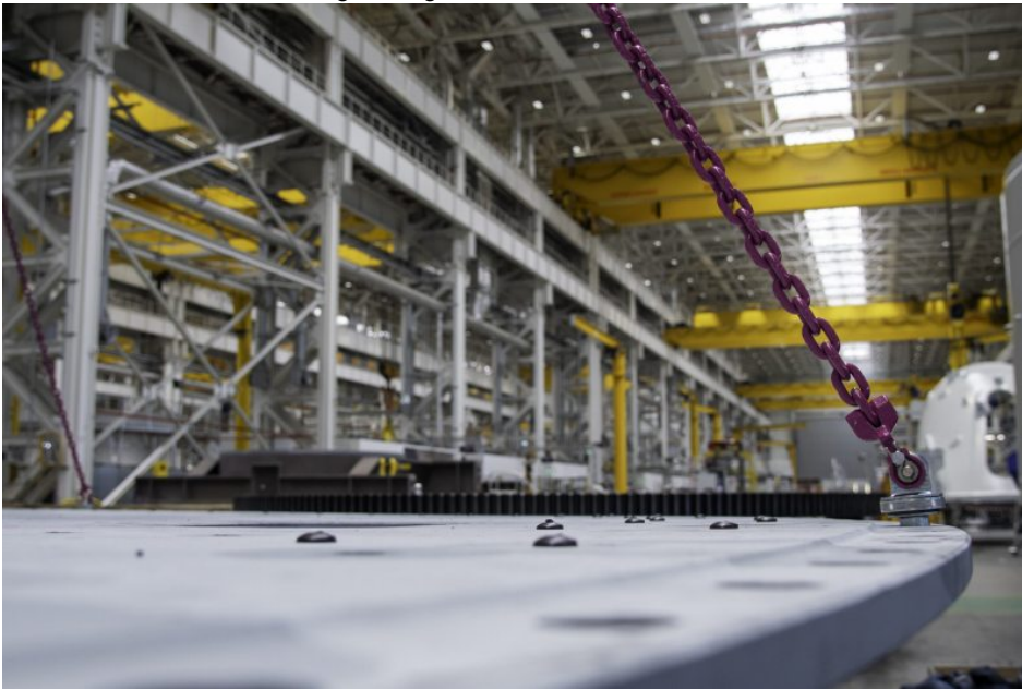
Steck-Anschlagpunkt »PIP-Rapido« in Kombination mit »CCS-Fastlox« (Bild: RUD).
