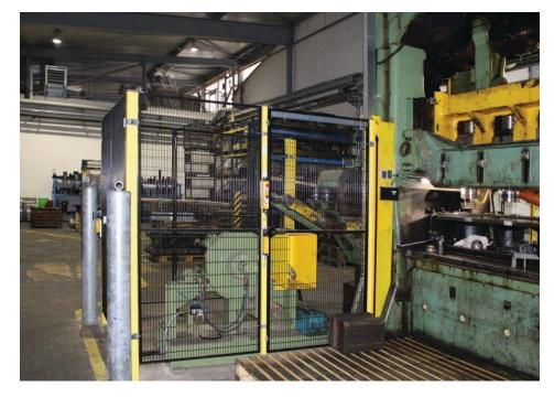
Im Rahmen der Modernisierung der Stufenpresse sollte die Steuerungstechnik aktualisiert und die vorhandenen Sicherheitseinrichtungen auf den neuesten technischen Stand gebracht werden (Bild: Bauer Group/Pilz).
