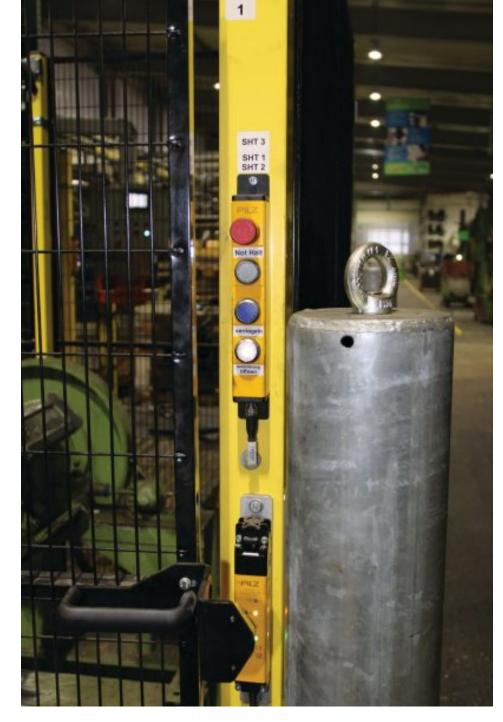
Die Bauer-Stufenpresse ist im Bereich der Coilabwicklung, der Bandzuführung sowie in der seitlichen Werkstückausbringung durch Schutzzäune mit Schutztüren abgesichert – die Verriegelung und Zuhaltung wurde mit der Sicherheitszuhaltung »PSENmlock« von Pilz umgesetzt (Bild: Bauer Group/Pilz).
