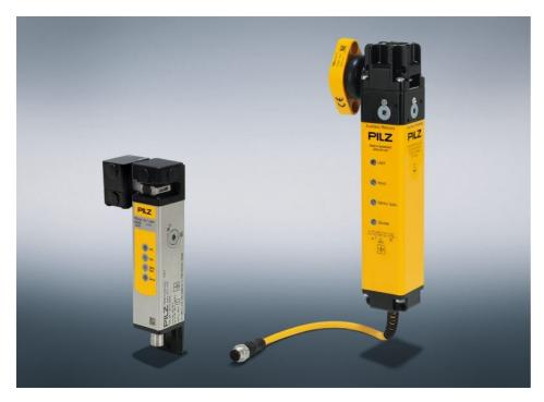
Für den Personenschutz wird häufig das bistabile Zuhalteprinzip eingesetzt. Dieses kommt beispielsweise auch bei den Sicherheitszuhaltungen »PSENmlock« und »PSENmlock mini« (li.) zum Einsatz. Der letzte Zustand bleibt im Fall eines Stromausfalls erhalten: entweder geschlossen und zugehalten oder offen (Bild: Pilz).
