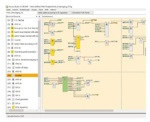
Über die Programmiersoftware können auf zeichnerischem Wege einfach Programme erstellt werden (Bild: Fiessler Elektronik).
