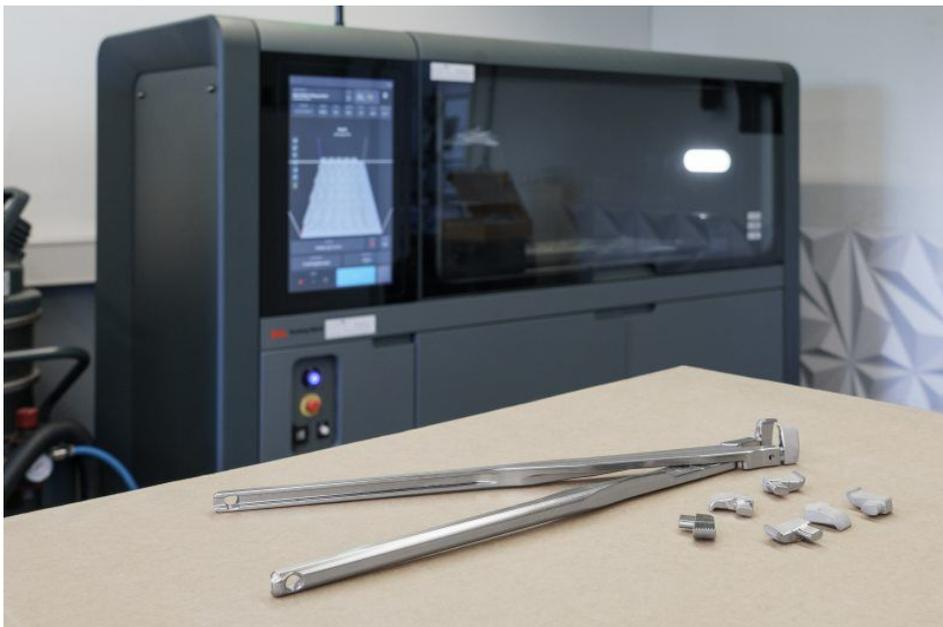
Bei BAK Kohler Medical integriert sich das 3D-Druck-Shop-System für die Serienproduktion von Bauteilen beinahe nahtlos in den Fertigungsprozess (Bild: SolidCAM).
