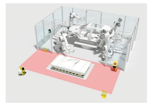
Das Sicherheitsprogramm passt das Schutzfeld dynamisch um das sich bewegende FTS an. Es kann so automatisiert in die Station einfahren, an der Parkposition das Material übergeben und anschließend die Station wieder verlassen (Bild: Leuze).
