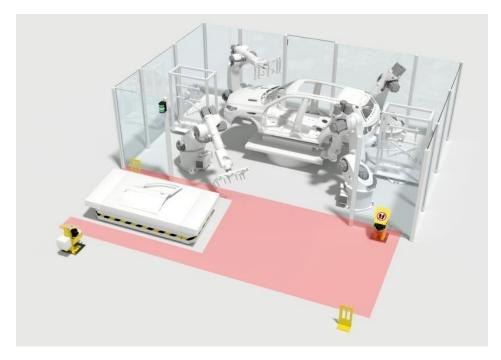
Sicherheits-Laserscanner überwachen den gesamten Bereich der Übergabestation für Roboterzelle und FTS. Ihre Schutzfelder erkennen den Zugang und die Anwesenheit von Personen. Der Umriss des FTS wird bei der Durchfahrt dynamisch aus den Schutzfeldern ausgeblendet (Bild: Leuze).
