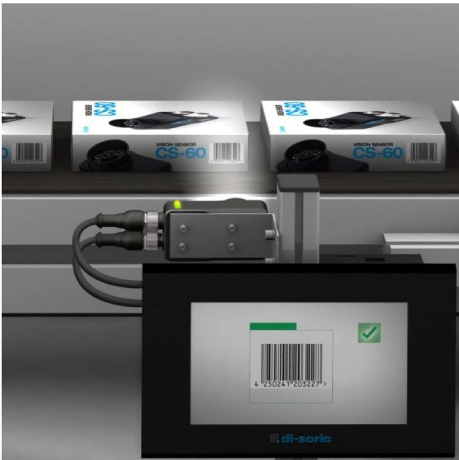
Anwendungsbeispiel Qualitätsprüfung und Erfassung von Barcodes im Rahmen der Sekundärverpackung (Bild: di-soric).
