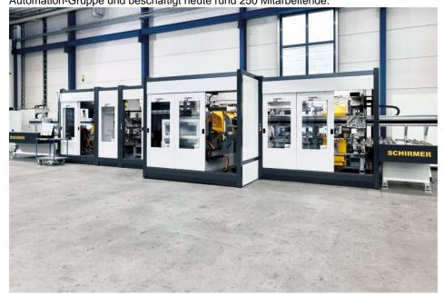
Bei dieser 14 Meter langen Schirmer-Maschine für die vollautomatische Bearbeitung von PVC-Fensterprofilen wurden mit dem »MX-System« erstmals alle bislang erforderlichen Schaltschränke ersetzt. Die Maschine konnte dadurch nicht nur kompakter konstruiert werden, auch die Effizienz der Arbeitsabläufe wurde erhöht (Bild: Beckhoff).
