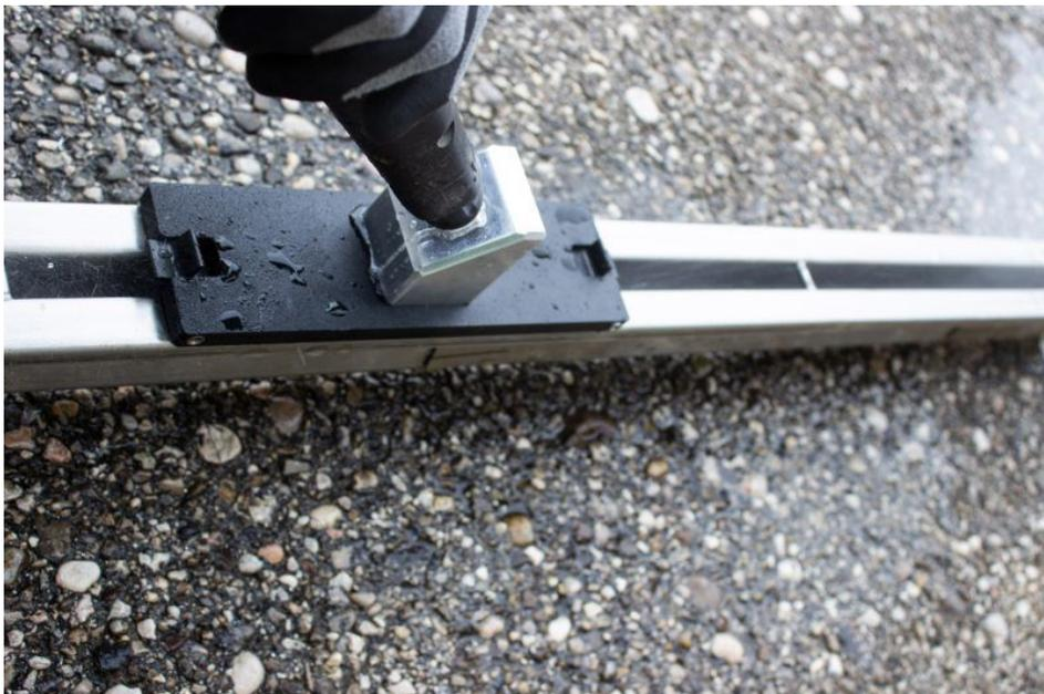
Für eine komfortable Reinigung sind spezielle Reinigungsdüsen verfügbar. Die Düse wird an die Lanze des Hochdruckreinigers angeschlossen und reinigt mit einem V-Strahl die Rinnenlängsseiten (Bild: Aschl).
