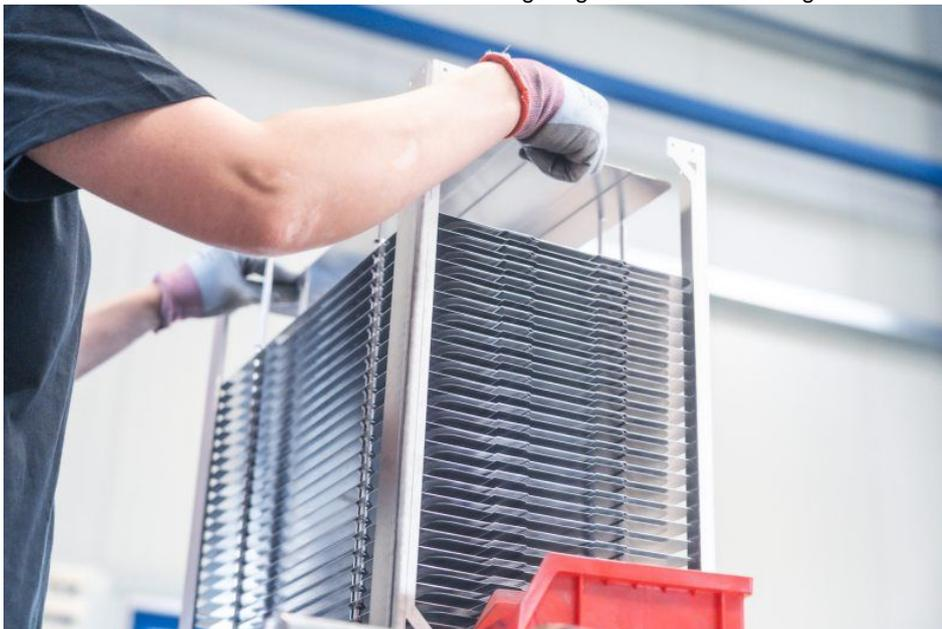
Die eingesetzten Elektrofilter produziert Büchel selbst in der eigenen Fertigung in Asselfingen (Bild: Büchel).
