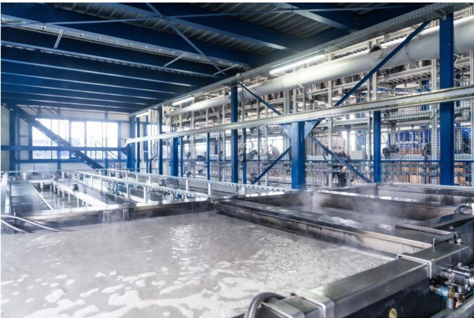
Ultraschallwaschanlage für die nachhaltige Reinigung der Filter (Bild: Büchel).
