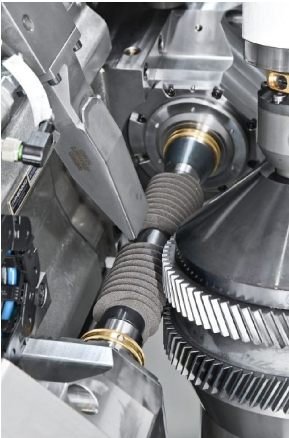
Robuste, abrichtbare CBN-Schleifschnecke (Bild: Liebherr).
