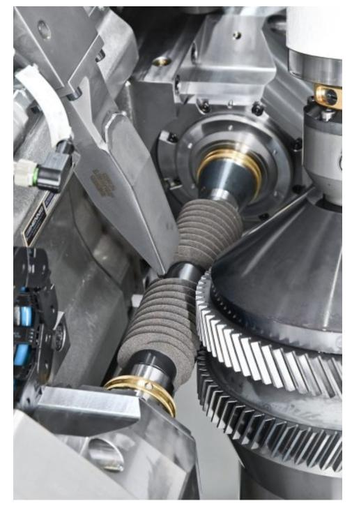
Robuste, abrichtbare CBN-Schleifschnecke (Bild: Liebherr).
