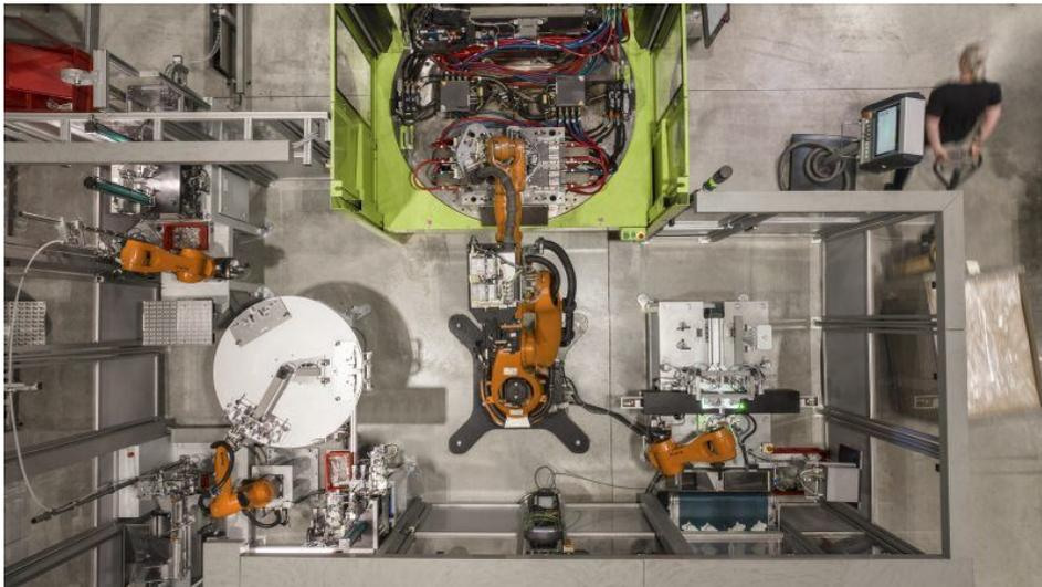
Die Fertigung der mit Kontakten und einer Achse bestückten Gehäuseteile ist automatisiert (Bild: Hermle).
