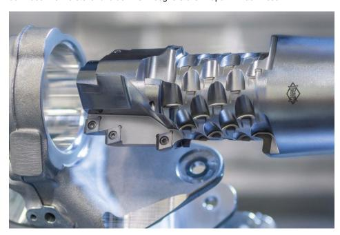
Das Kombinationsaufbohrwerkzeug mit gelöteten PKD-Schneiden und ISO-Wendeschneidplatten bietet höchstmögliche Stabilität und Standzeit in der Vorbearbeitung bei bestmöglichen Oberflächenergebnissen für definierte Oberflächen (Bild: Mapal).
