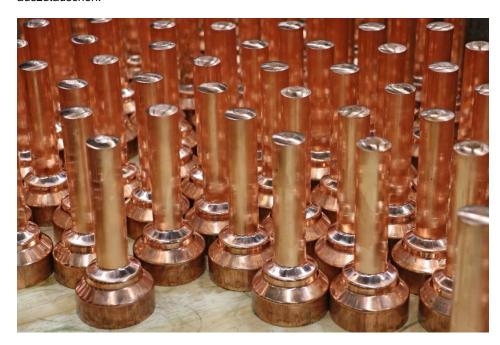
Für größere Kontaktstäbe werden vorgeformte Kupferrohlinge eingesetzt (Bild: Index).
