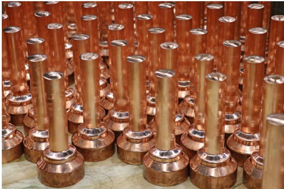
Für größere Kontaktstäbe werden vorgeformte Kupferrohlinge eingesetzt (Bild: Index).
