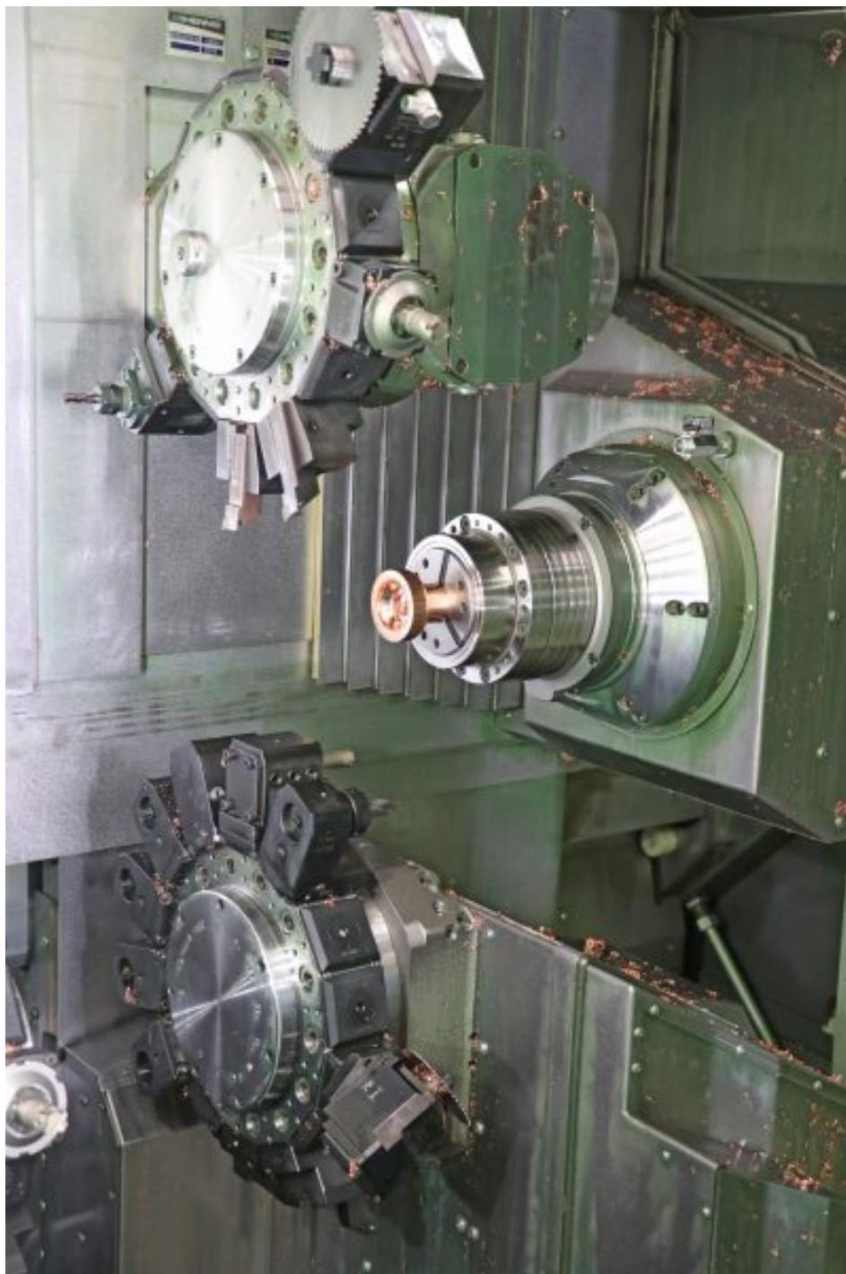
Drei Revolver mit jeweils 14 Werkzeugplätzen plus eine Frässpindel gewährleisten eine wirtschaftliche Komplettbearbeitung (Bild: Index).
