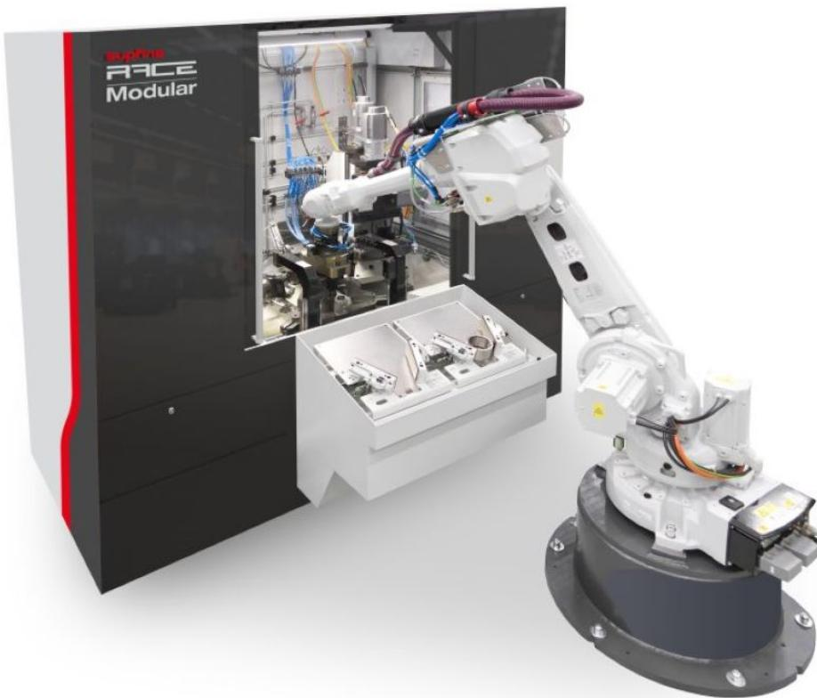
Die neue Superfinish-Maschinenbaureihe »Race Modular« ist für den 24/7-Betrieb ohne Bedienpersonal ausgelegt (Bild: Supfina).
