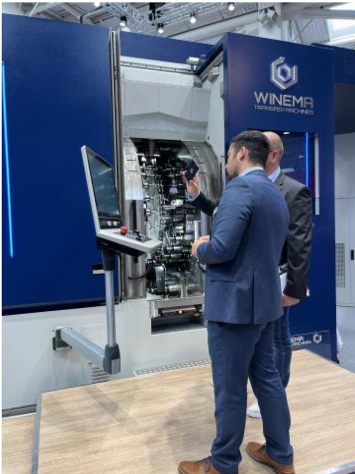
Die Transfermaschine für die Hochvolumenproduktion verfügt über ein integriertes Werkzeugmanagement (Bild: Winema).
