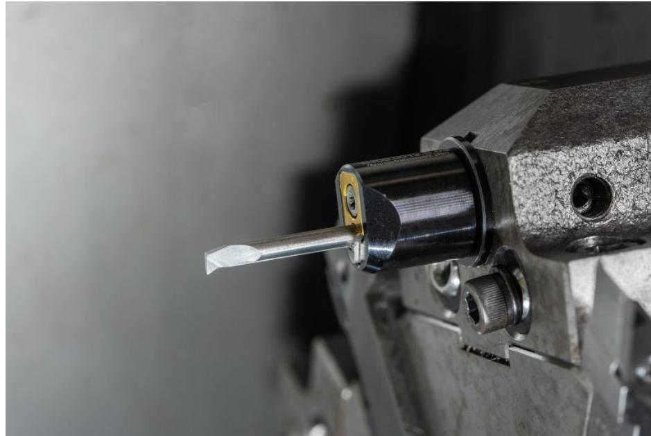
Zum Innenausdrehen setzt Böhm auf »Supermini Typ 105« (Bild: Horn/Sauermann).
