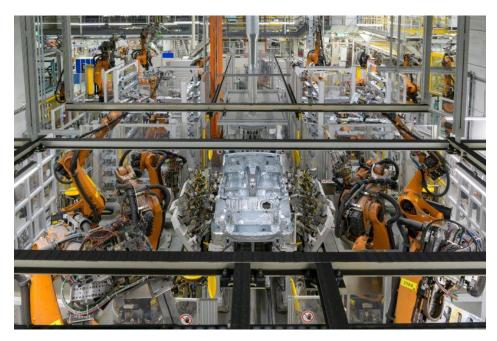
Für den Karosseriebau werden viele Roboterleistungen benötigt. Sie alle werden im Werk Dingolfing mit Gleichstrom angetrieben und sparen so eine Menge Energie (Bild: Lapp/Daniel Schvarcz).
