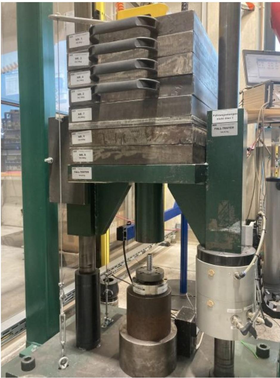
Die Dämpfer werden an Vertikal-Falltestern geprüft, die bei einer maximalen Fallhöhe von 1500 Millimetern für Massenkräfte von 3 bis 500 Kilogramm und maximale Aufprallgeschwindigkeiten von bis zu circa 5,5 Metern pro Sekunde ausgelegt sind (Bild: ACE).
