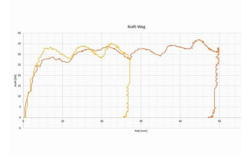
Crash-Dämpfer bieten hohe Energieaufnahmen sowie geringe Stützkräfte bei langem Hub, hier bestätigt durch die Messtechnik und veranschaulicht anhand ihres Dämpfungsverhaltens bei maximaler und bei halber Hubnutzung (Bild: ACE).
