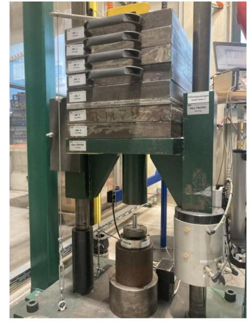
Die Dämpfer werden an Vertikal-Falltestern geprüft, die bei einer maximalen Fallhöhe von 1500 Millimetern für Massenkräfte von 3 bis 500 Kilogramm und maximale Aufprallgeschwindigkeiten von bis zu circa 5,5 Metern pro Sekunde ausgelegt sind (Bild: ACE).
