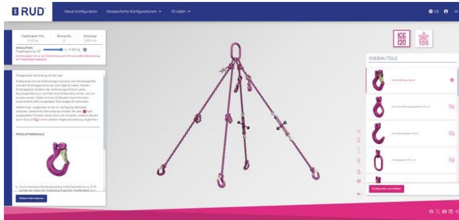
Im Anschlagmittelkonfigurator können Nutzlast und Nutzlänge, Aufhängeelement, Verkürzungselemente, Zwischenbauteile sowie Endbauteile definiert und ausgewählt werden (Bild: RUD).
