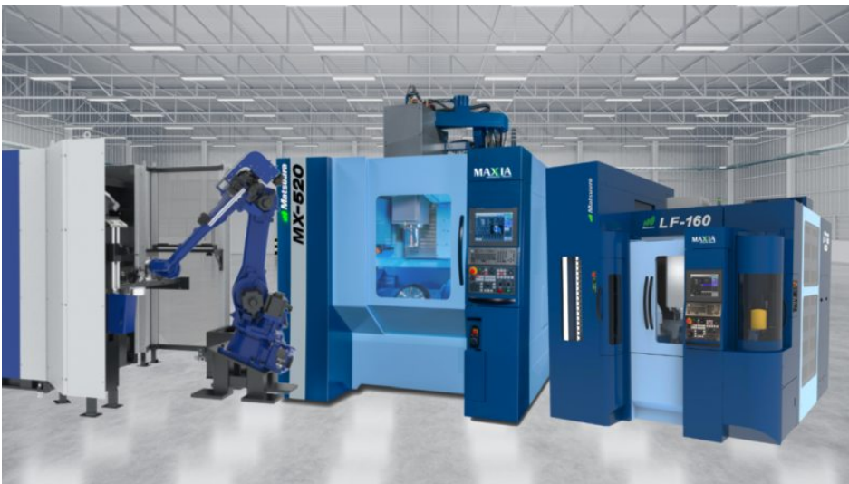
5-Achs-Vertikal-Bearbeitungszentrum mit Roboterzelle (Bild: Matsuura).
