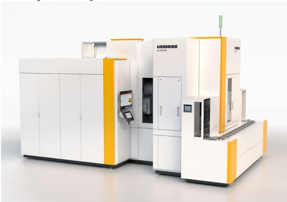
Die »LK 180/280« ermöglicht hauptzeitparalleles Anfasen. Bild: Liebherr
