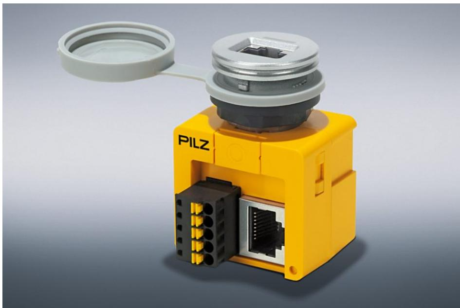
Das neue Bedienelement mit aktivierbaren Ethernet-Port schützt Netzwerkverbindungen wie eine Firewall vor unbefugtem Zugriff von außen und innen (Bild: Pilz).
