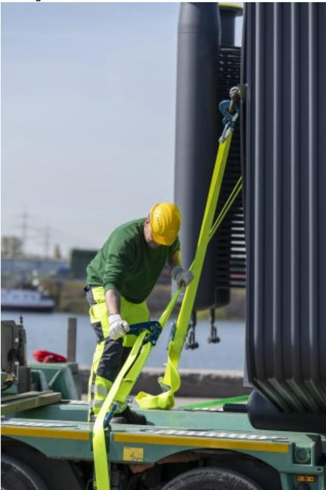
Mit dem Schwerlastzurrgurt können auch schwere Lasten ordnungsgemäß gesichert werden (Bild: Spanset).
