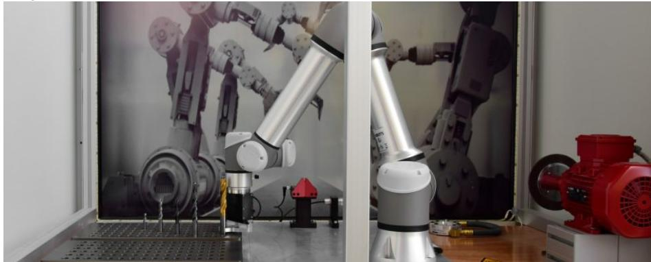
Mit der Roboterzelle können Schneidkanten von Werkzeugen gezielt und reproduzierbar optimiert werden (Bild: GDS).
