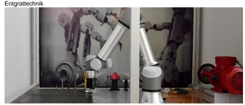
Mit der Roboterzelle können Schneidkanten von Werkzeugen gezielt und reproduzierbar optimiert werden (Bild: GDS).
