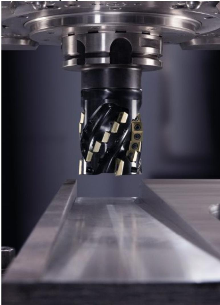
Die stirnseitig eingesetzten Systemwendeplatten des Igelfräzers sind auch in Eckfräsern einsetzbar (Bild: Walter).
