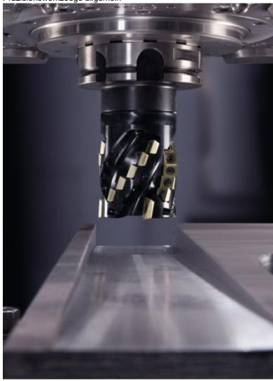
Die stirnseitig eingesetzten Systemwendeplatten des Igelfräsers sind auch in Eckfräsern einsetzbar (Bild: Walter).
