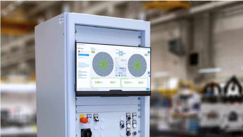
Die Retrofit-Maßnahme umfasst auch die Software, die im Auswuchtprozess zum Einsatz kommt (Bild: Schenck Rotec).
