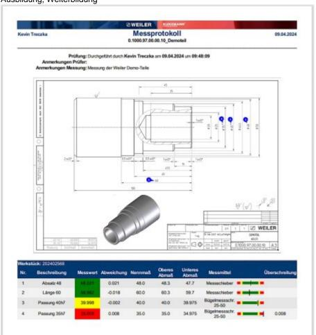
Die neue Lerneinheit vermittelt, wie Werkstücke nach der Bearbeitung mit integrierten Handmessmitteln an der Maschine kontrolliert werden können (Bild: Weiler).
