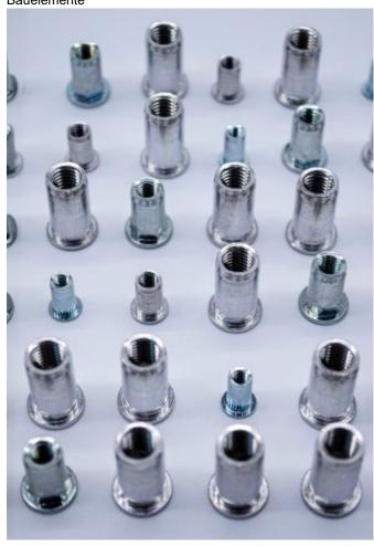
Blindnietmuttern kommen überall dort zum Einsatz, wo tragfähige und hochwertige Gewinde in dünne Bleche eingebracht werden müssen (Bild: SFS/Gesipa).
