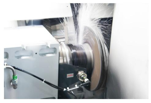
Schleifprozess von beschichteten Bremsscheiben (Bild: Supfina).
