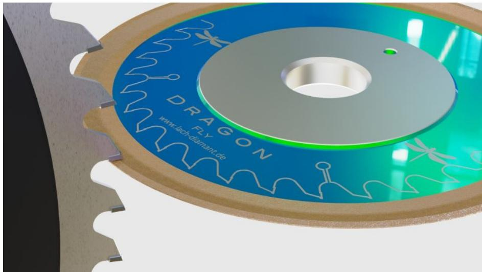
Die neue Diamant-Schleifscheibe sorgt für sehr hohe Präzision und Stabilität bei der Bearbeitung hartmetallbestückter Sägen (Bild: Lach).
