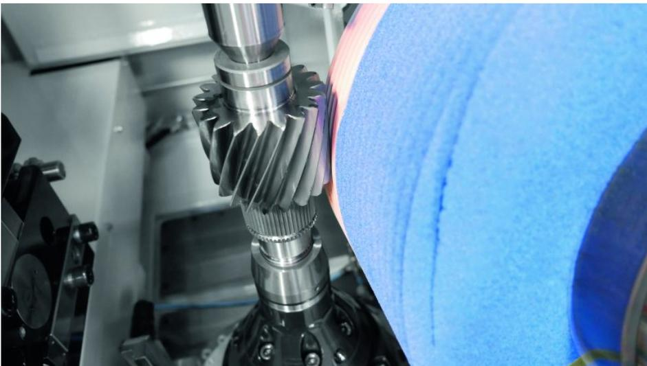
Konventionelles Wälzschleifen und Feinschleifen mit kombiniertem Werkzeug (Bild: Kapp Niles).
