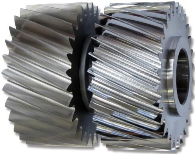
Links Verzahnung nach konventionellem Wälzschleifprozess, rechts Verzahnung nach dem Polierschleifprozess (Bild: Kapp Niles).
