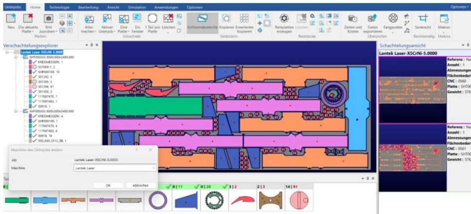
Fällt eine Maschine aus, können Schachtelpläne mit der CAD/CAM-Software auf eine andere Maschine übertragen werden (Bild: Lantek).
