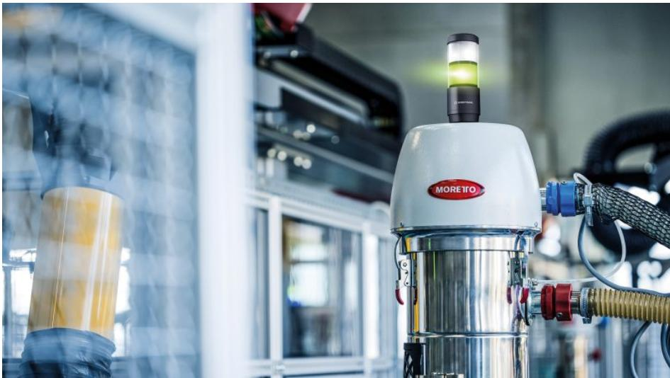
Die kompakte LED-Signalsäule bietet 360°-Sichtbarkeit (Bild: Werma).
