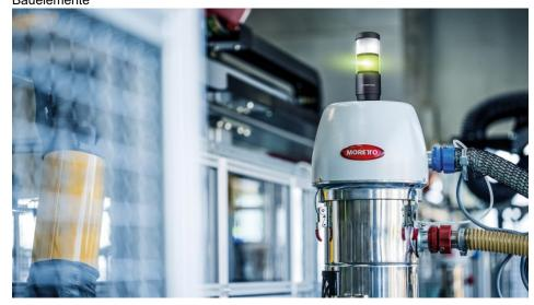
Die kompakte LED-Signalsäule bietet 360°-Sichtbarkeit (Bild: Werma).
