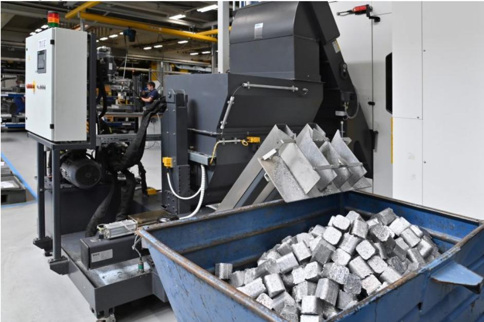
Die Brikettieranlagen arbeiten personallos direkt an den Bearbeitungszentren (Bild: Ruf Maschinenbau).
