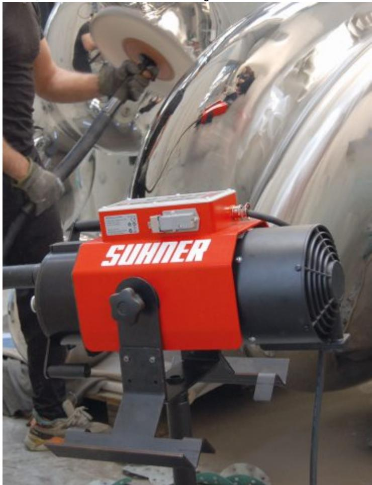
Rohling während der Bearbeitung mit der biegsamen Wellenmaschine (Bild: Suhner).
