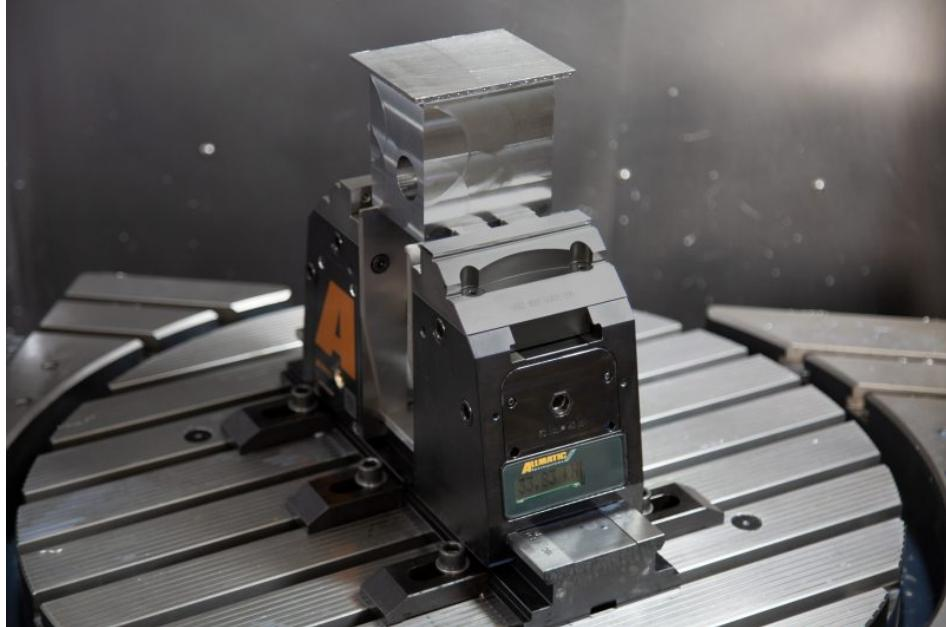
Der 5-Achs-Schraubstock ist auch mit integrierter Spannkraftüberwachung erhältlich
