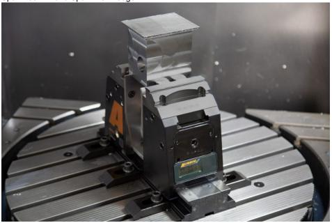
Der 5-Achs-Schraubstock ist auch mit integrierter Spannkraftüberwachung erhältlich (Bild: Allmatic).
