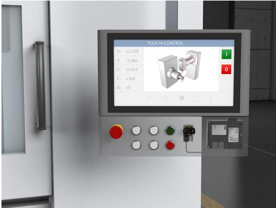
Das modulare elektronische Schlüsselsystem ist jetzt noch einfacher zu integrieren (Bild: Euchner).
