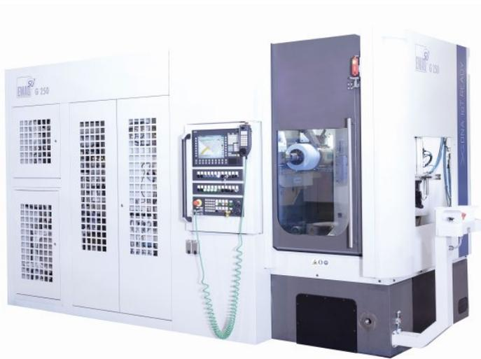
Die Wälzschleifmaschine arbeitet sehr präzise und bietet minimale Span-zu-Span-Zeiten sowie kurze Rüstzeiten (Bild: Emag).
