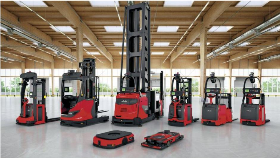
Von klein bis groß reicht das Portfolio an fahrerlosen Transportsystemen und mobilen Robotern (Bild: Linde Material Handling).
