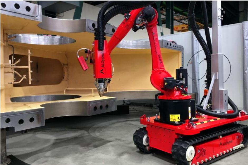
Flexible Laserbearbeitungsanlage für Laserhärten, Laserauftragschweißen und CMT-Schweißen (Bild: Alotec).
