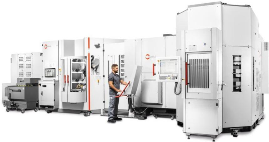
Handlingsystem »HS flex heavy« adaptiert an ein 5-Achs-Bearbeitungszentrum »C 650« (Bild: Hermle).
