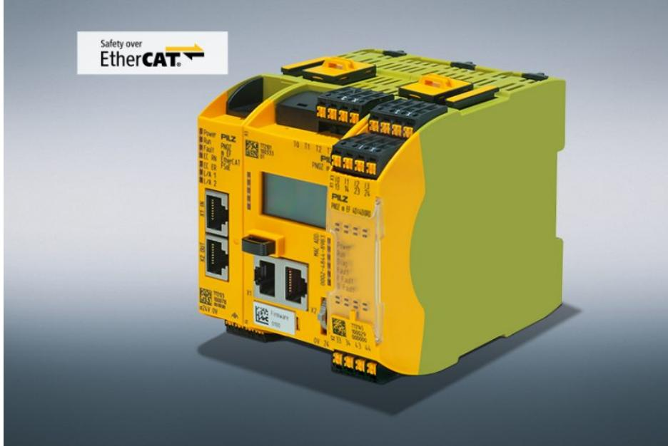
Die sichere und konfigurierbare Kleinststeuerung bietet auch das offene Kommunikationssystem Ethercat in Kombination mit dem sicheren Protokoll Safety-over-Ethercat FSofE (Bild: Pilz).
